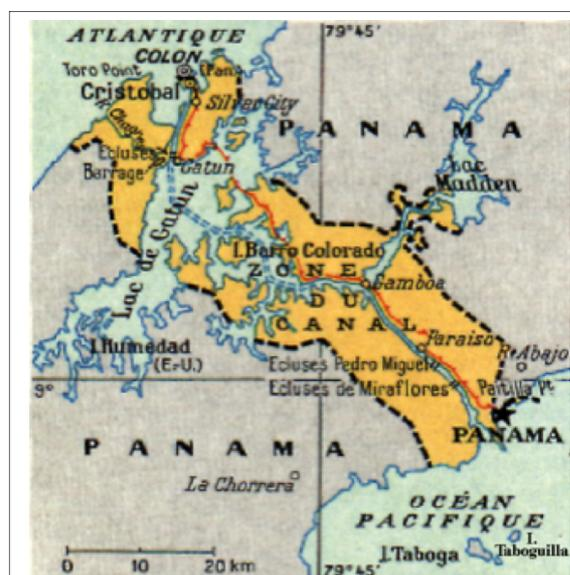
LE CANAL DE PANAMÁ : Par l'écluse de Gatún, réalisée en trois sas, les navires montent de la baie de Limon, en mer des Caraïbes, jusqu'au lac de Gatún, 25,9 m plus haut. Chaque sas est long de 305 m et large de 33,5 m. La profondeur initiale minimum est de 12 m. C'est tirés par un remorqueur, tandis qu'ils sont maintenus dans l'axe de l'écluse par des câbles tendus à partir de petites locomotives qui avancent sur les bords du sas en même temps qu'eux, que les voiliers progressent.
