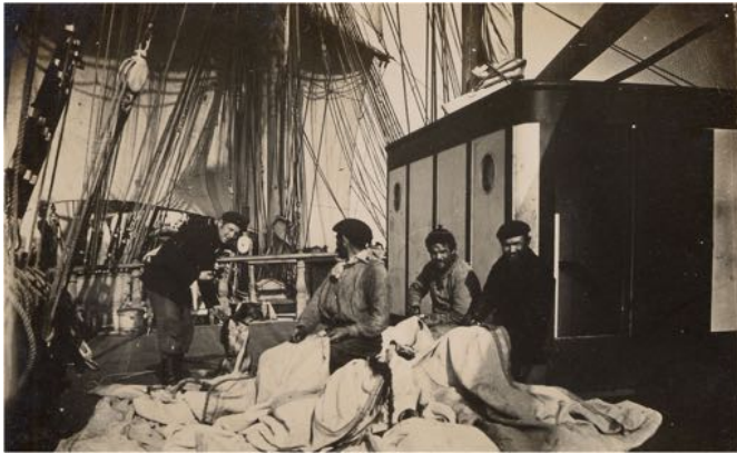
Les voiles sont vite endommagées quand le navire rencontre des vents violents. À bord, les "voiliers" les réparent et en font de nouvelles.
