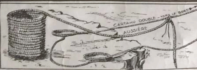
2 A terre, les sauveteurs amorent le bout de l'aussière sur l'un des doubles du cartahu. Ils aident sur l'autre double du cartahu pour envoyer l'aussière à bord.
